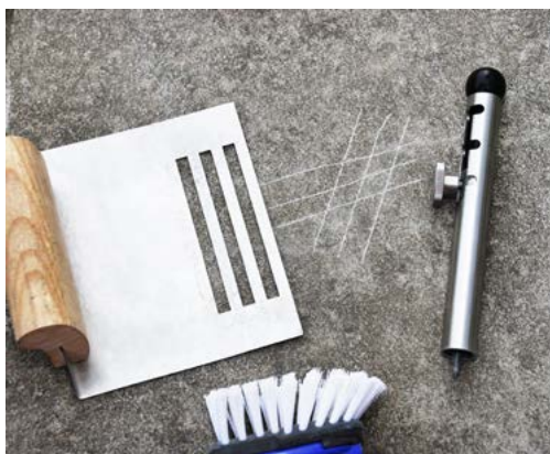
Správně provedená vrypová zkouška
