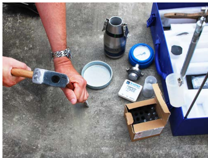
Měření vlhkosti podkladu pomocí CM přístroje
