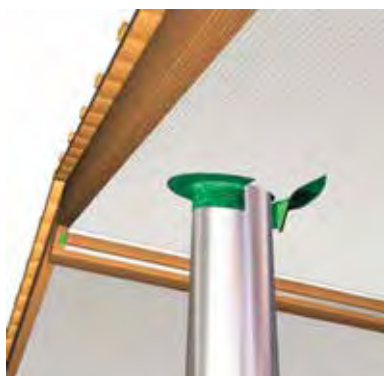
Obr. 12 - Řešení průchodu superflexibilní páskou
