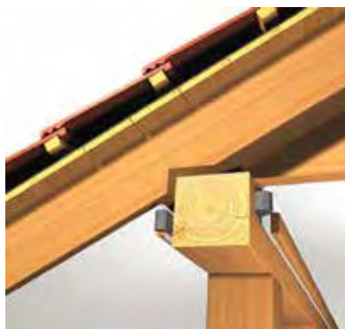
Obr. 5 - Dotěsnění u vaznice krovu
